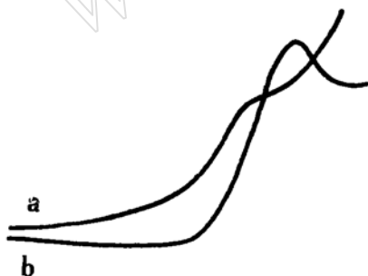
图5 直流极谱与常规极谱图 a. 样品DC直流极谱 ( 10\mu\text{A} ) b. 常规脉冲极谱 ( 100\mu\text{A} ) 扫描速率 5\text{mv/s}
