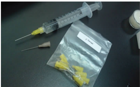
图 3 控制液滴大小的针头(针头标准:27 Gauge) Fig.3 The needle for controlling the droplet size
