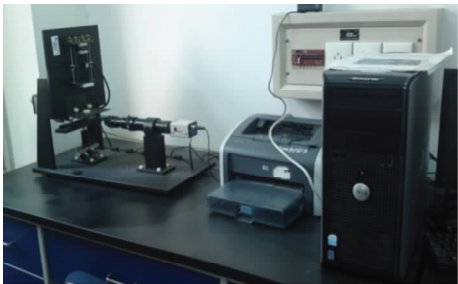
图 2 FTA200 表面张力仪 Fig.2 FTA200 dynamic surface tension meter
