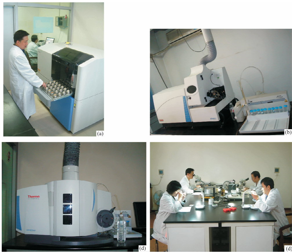
图 1 实验室主要仪器 (a)—X 射线荧光光谱仪；(b)—电感耦合等离子体质谱仪；(c)—电感耦合等离子体发射光谱仪；(d)—珠宝检测。
