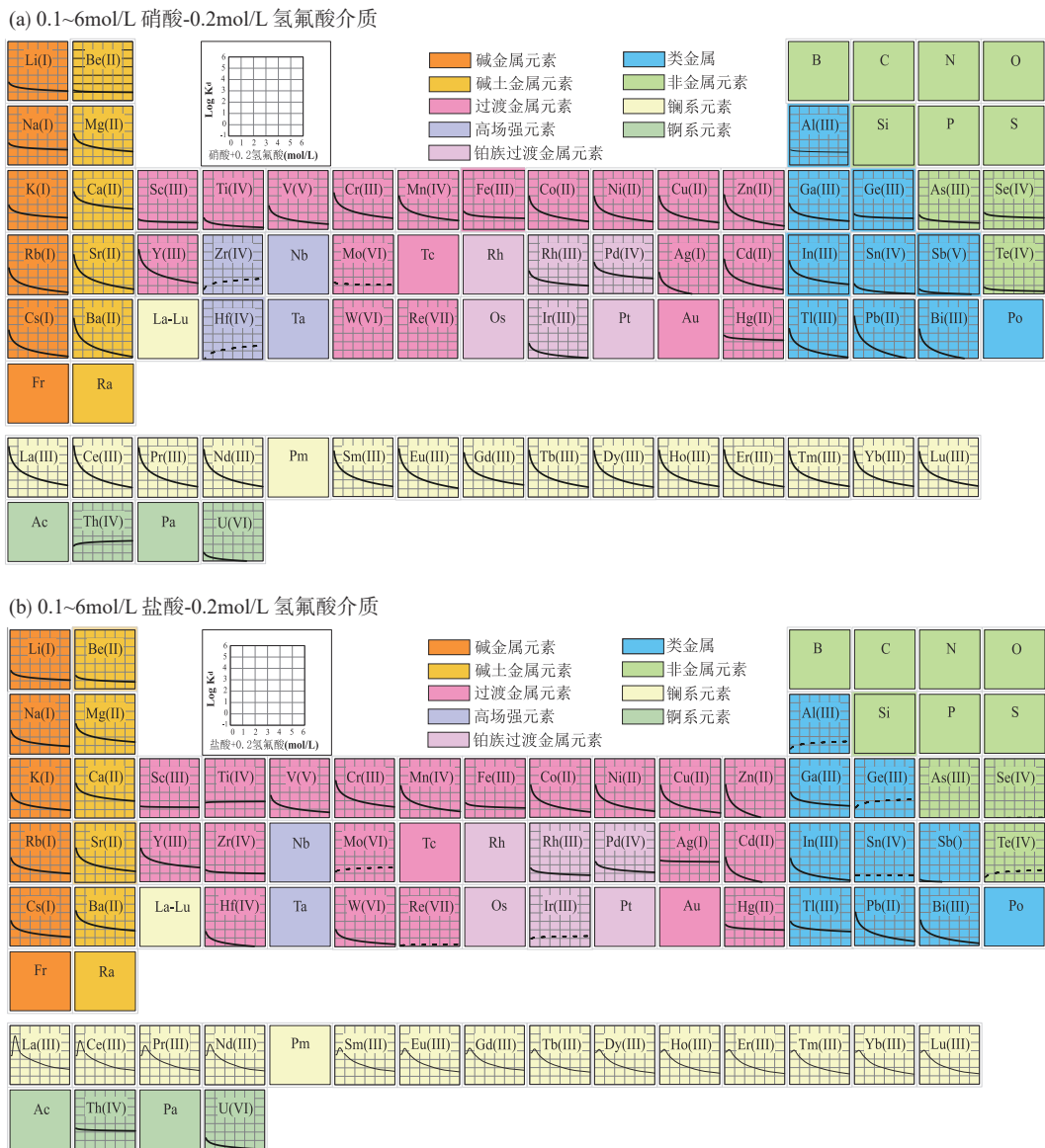
图4 AG ® 50W-X8 阳离子交换树脂在 (a) 0.1~6mol/L 硝酸-0.2mol/L 氢氟酸介质; (b) 0.1~6mol/L 盐酸-0.2mol/L 氢氟酸介质中的元素分配系数
