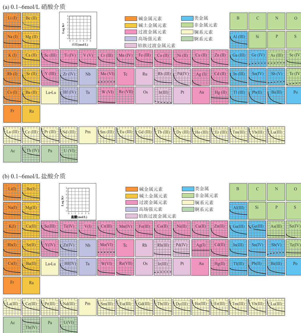
图3 AG^{®}50W-X8 阳离子交换树脂在 (a) 0.1~6mol/L 硝酸介质和 (b) 0.1~6mol/L 盐酸介质中的元素分配系数 (纵坐标为对数坐标, 图中虚线代表在树脂中不吸附的元素)
